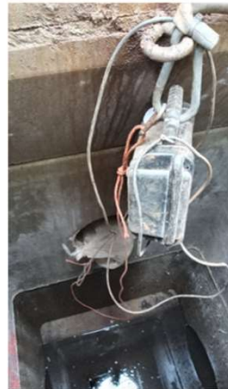
Figuur 1 Voorbeeld resultaten metingen met RioolPutSensor in HWA-riolering (links) en de wijze waarop een RioolPutSensor in een buis wordt geplaatst.
