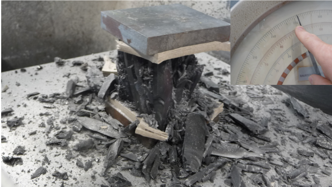
FIGUUR 21 SMELTGEGOTEN TESTBLOK NA BEZWIJKEN IN COMPRESSIETEST
