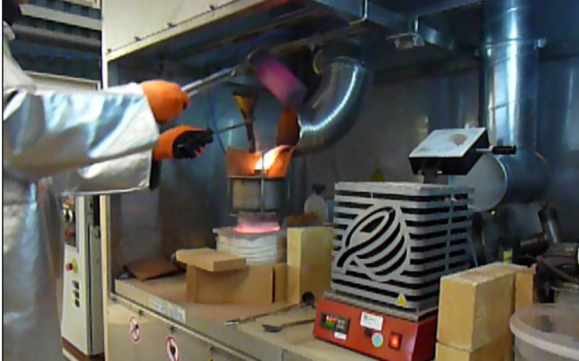
FIGUUR 3 MOMENT VAN ONTSTEKEN VAN EEN GEDOSEERD REACTIEF MENGSEL
