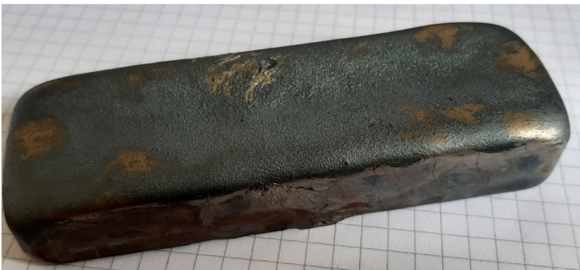
FIGUUR 11 OMGESMOLTEN FERROFOSFOR
