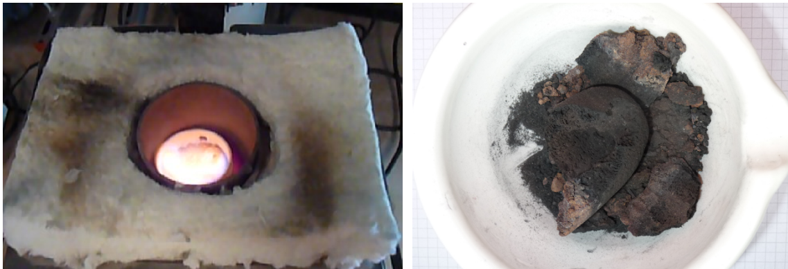
FIGUUR 24 ROOSTEN VAN DE FERROFOSFOR; INHOUD NA 1 UUR
