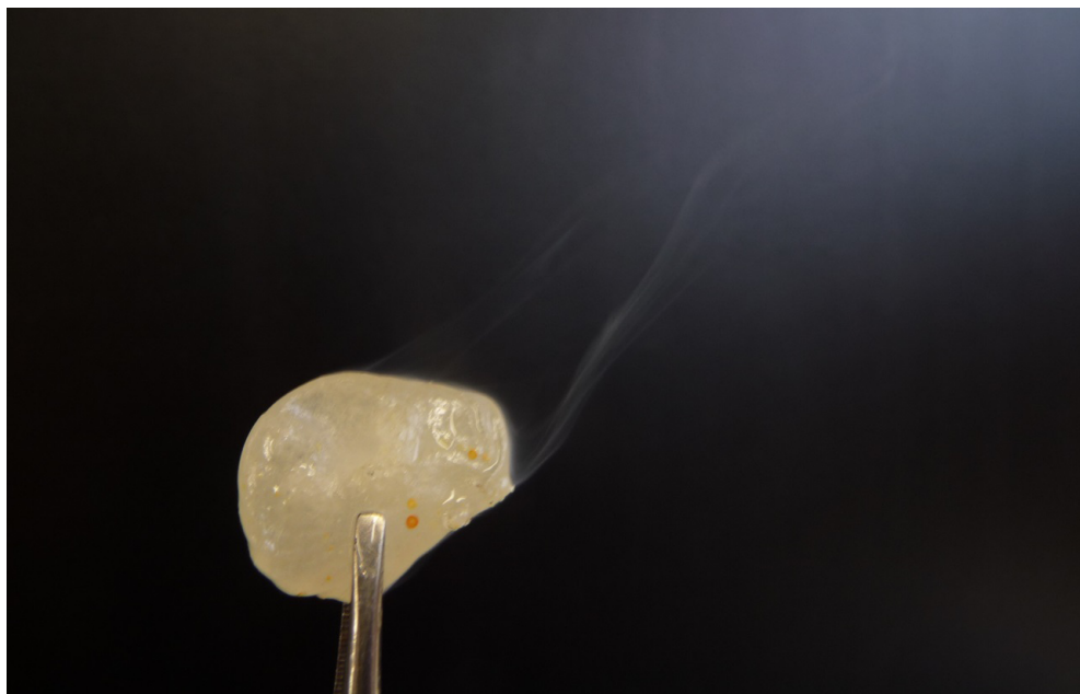
FIGUUR 13 WITTE FOSFOR, GEDESTILLEERD UIT SUSPENSIE EN FOSFORSLIB
