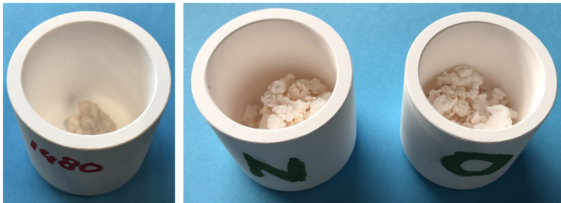
FIGUUR 19 GEËXPANDEERDE SLAK NA BLOOTSTELLING AAN 1480°C (LINKS) EN 1350°C (RECHTS, IN DUPLO)
