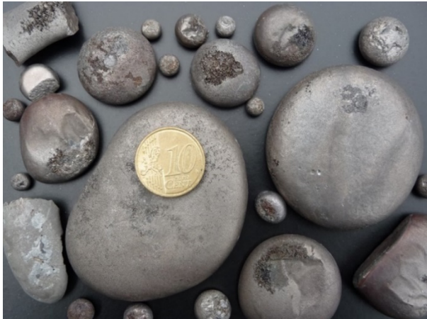
FIGUUR 10 FERROFOSFOR ZOALS VERZAMELD NA HET OMSMELTEN VAN DE SLAK
