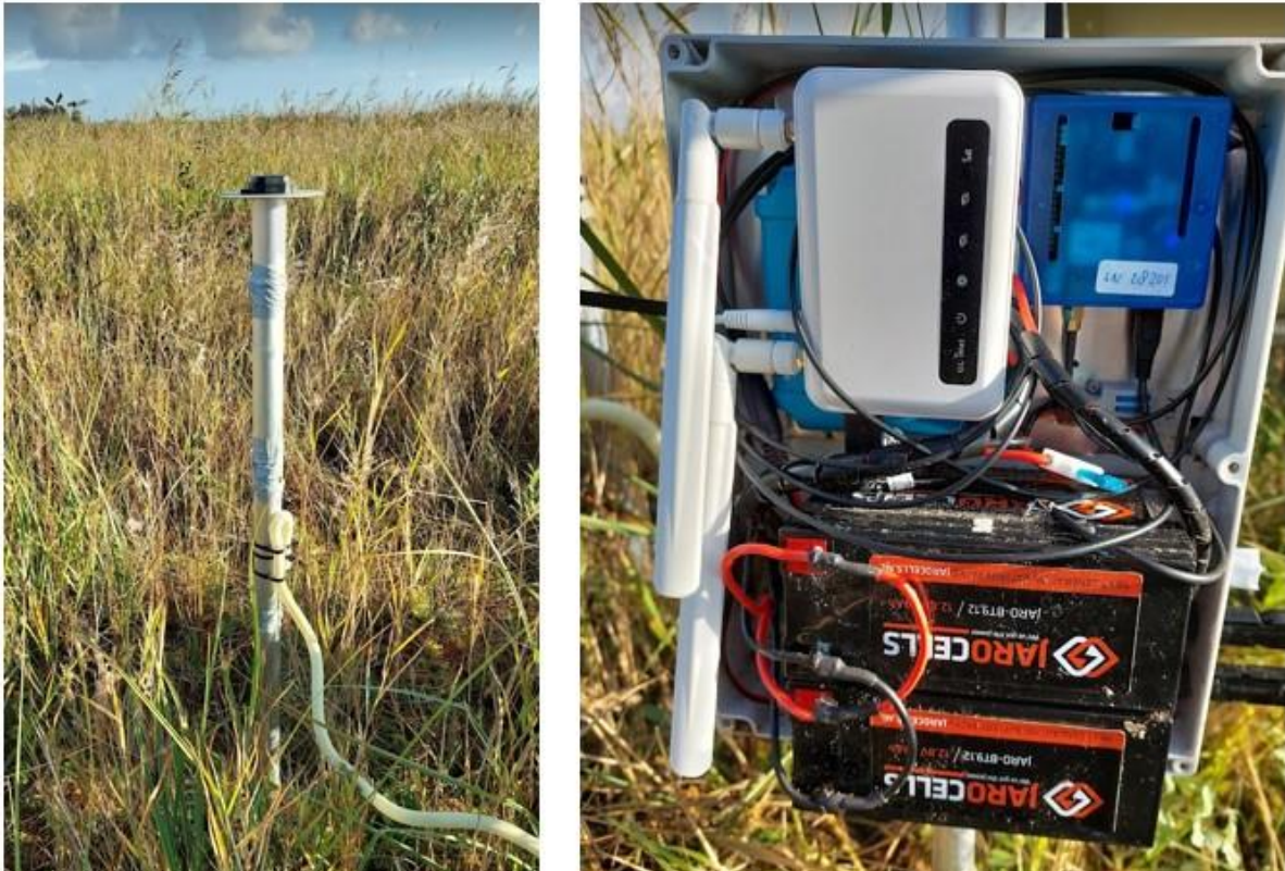
Figuur 11. GNSS ontvanger in de Weerribben, met links de GNSS antenne gemonteerd op een "drijvend" rooster, en rechts de GNSS ontvanger, 4G OpenWrt data logger, en solar batterij.
