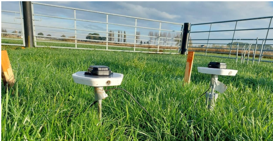
Figuur 13. Een GNSS, c.q. geodetische extensometer (GExt) opstelling op KTC Zegveld.
