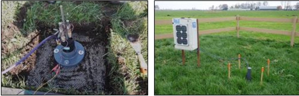
Figuur 8. Links: de bovenkant van een extensometer met een RVS plaat, flens en opnerhuis. Rechts: De meetsensoren van de extensometer, afgedekt met een kap, zijn met kabels bevestigd aan een datalogger met zonnepaneel.
