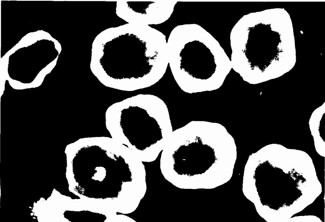
Figuur 5.9 De dragerdeeltjes zijn concentrisch omgeven door biofilmen met een dikte van 150-300 \mu\text{m} .
