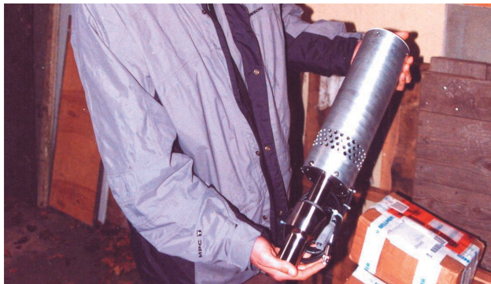
FIGUUR 24 SONOTRODE ULTRAWAVES , 2 KW GEINSTALLEERD VERMOGEN
