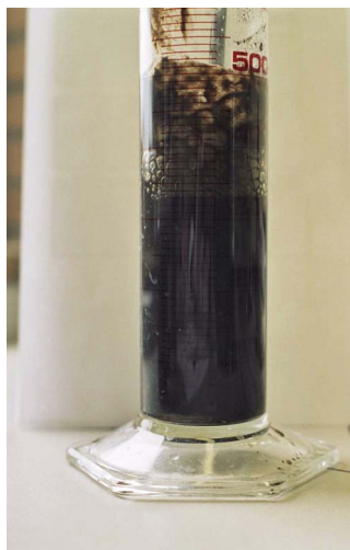
FIGUUR 4.1. BEPALING VAN DE SCHUIMPOTENTIE DOOR TOEVOEGING VAN INGEDIKT SPUISLIB VAN RWZI MEPEL AAN SLIB UIT DE SLIBGISTING (MULDER, 2006)
