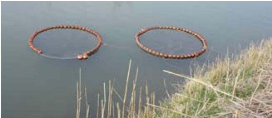
Fig 2.5 OPSLAGNETTEN MET VIS TER BEPALING VAN DE UITGESTELDE STERFTE
