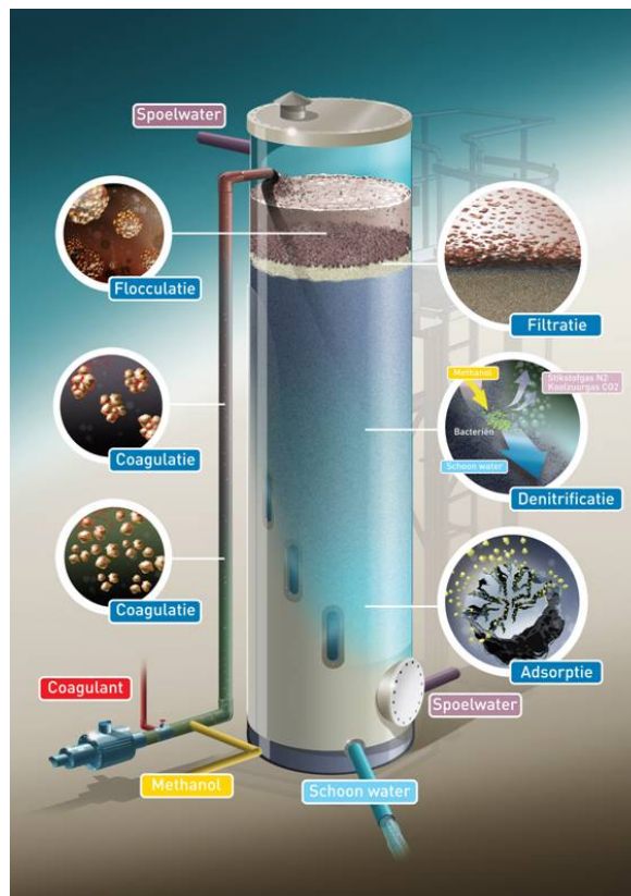
AFBEELDING 2.1 PROCESSEN IN HET 1-STEP® FILTER (BRON: STOWA RAPPORT 2009-34)
