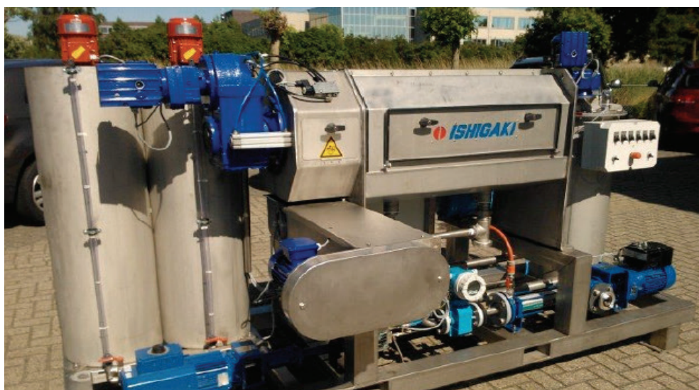
FIGUUR 3.1 KLEINSCHALIGE TESTINSTALLATIE SCHROEFPERS
