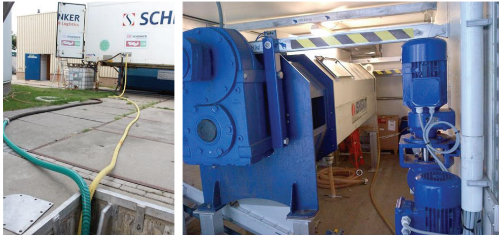
FIGUUR 3.2 CONTAINER MET AANVOERLEIDINGEN (LINKS) EN OPSTELLING VAN SCHROEFERS IN CONTAINER (RECHTS)
