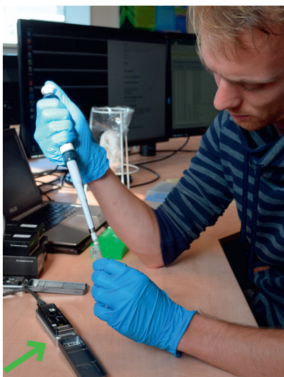
FIG 2.2 De MinION sequencer (zie groene pijl) in gebruik op het kantoor van Orvion.
