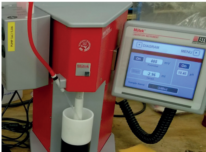
AFBEELDING 2 OPSTELLING STREAMING CURRENT
