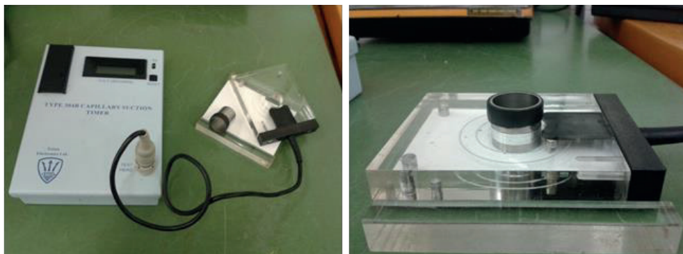
AFBEELDING 1 OPSTELLING CST-TEST MET EEN 304B CST VAN TRITON ELECTRONICS LTD
