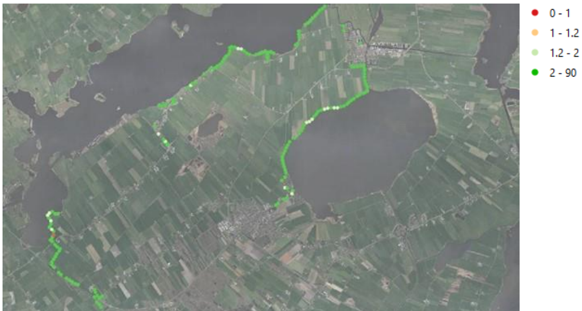
Figuur 4-6 Laagst berekende veiligheidsfactoren per locatie voor de kadering. De kleur van de locatie weerspiegelt de veiligheidsfactor.
