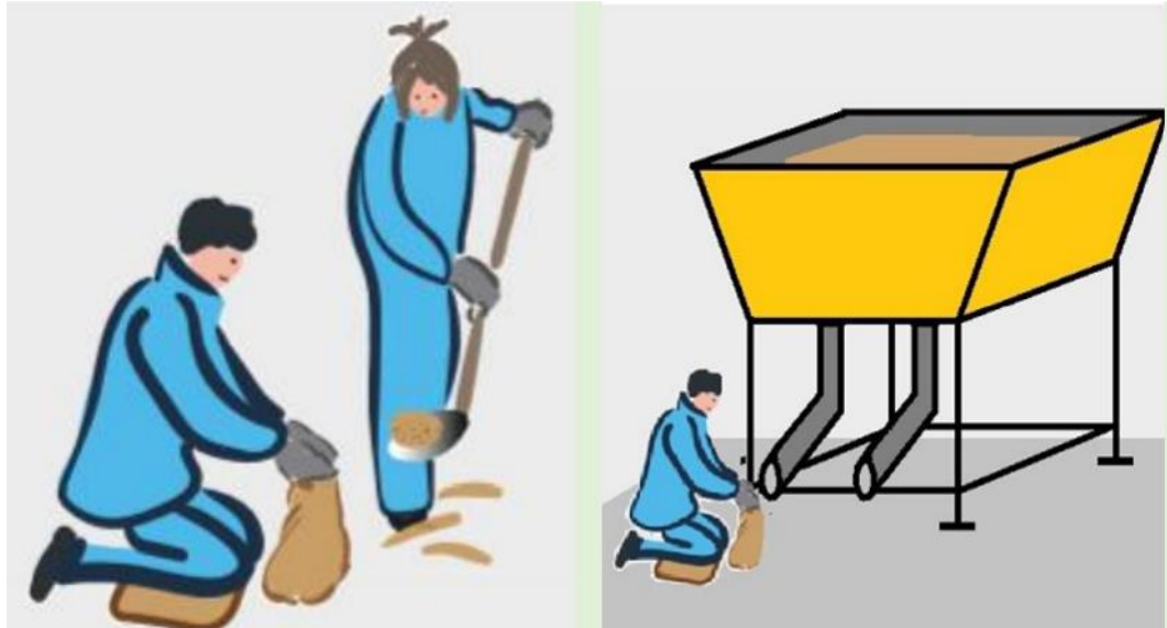
Figuur 4-5: Verschillende vulmethodes zandzakken
