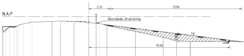
Figuur 21 Aangelegd dijkprofiel bij dijkversterking.
