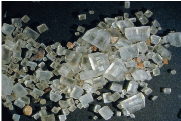
FIGUUR 49 STRUVIETKRISTALLEN (BRON: STOWA 2012-27) 74
