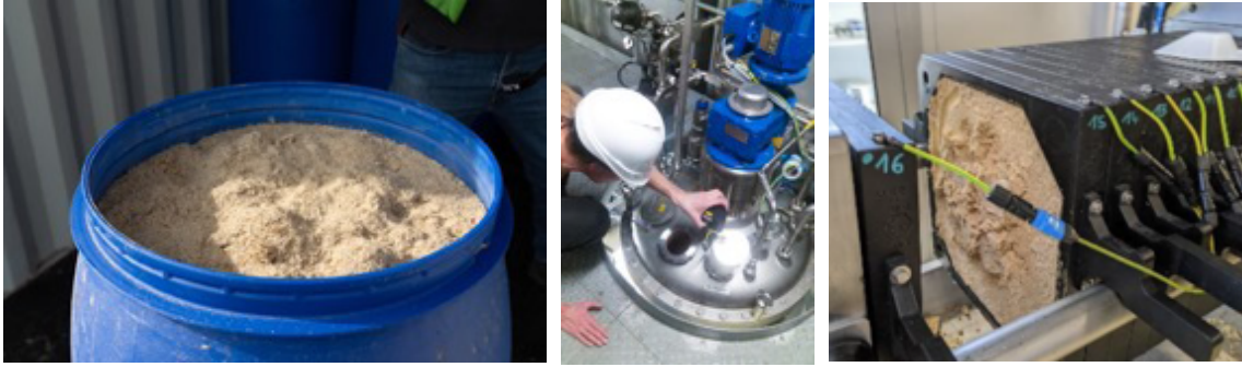
FIGUUR 4 VAN LINKS NAAR RECHTS: PHA-RIJK HALFFABRICAAT GEPRODUCEERD IN DORDRECHT, EXTRACTIE BIJ FRAUNHOFER IN DUITSLAND EN RUW CALEYDA® NA EXTRACTIE
