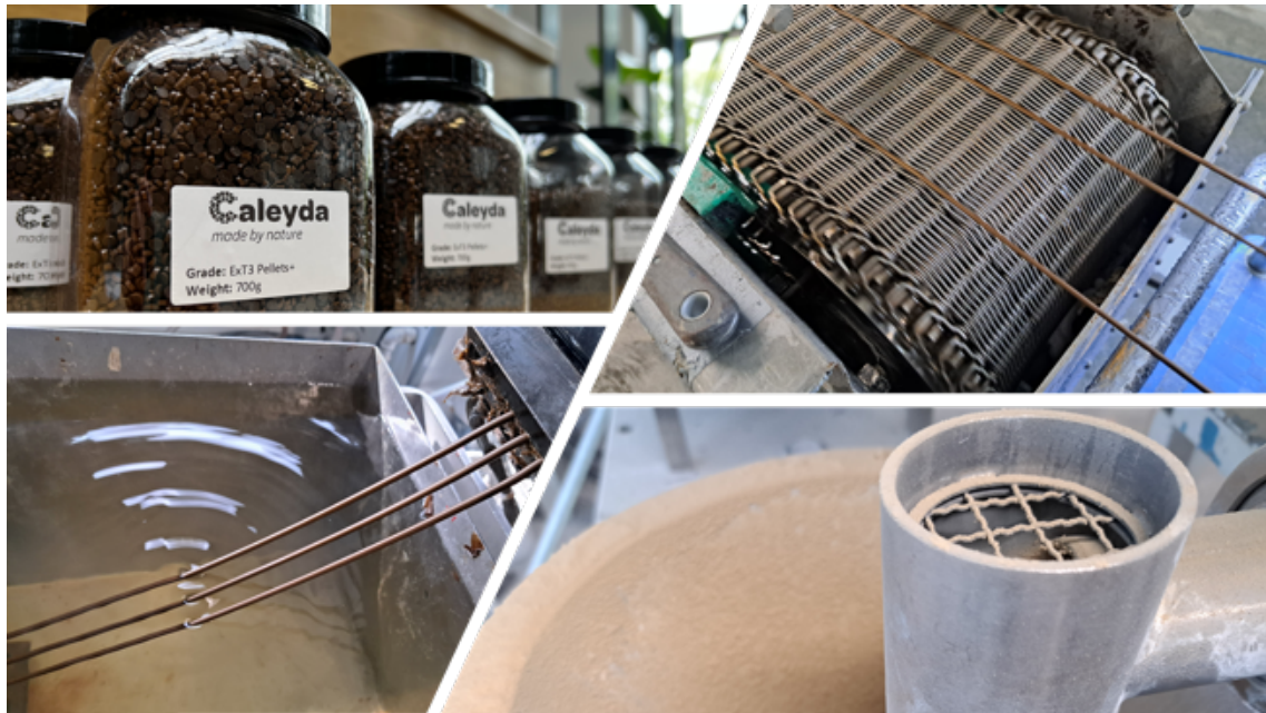
FIGUUR 12 LINKSBOVEN: CALEYDA-PELLETS, LINKSONDER GEËXTRUDEERD FILAMENT DAT DE EXTRUDER UITKOMT. RECHTSBOVEN: CALEYDA NA KOELBAD, RECHTSONDER: VOEDING AAN DE EXTRUDER
