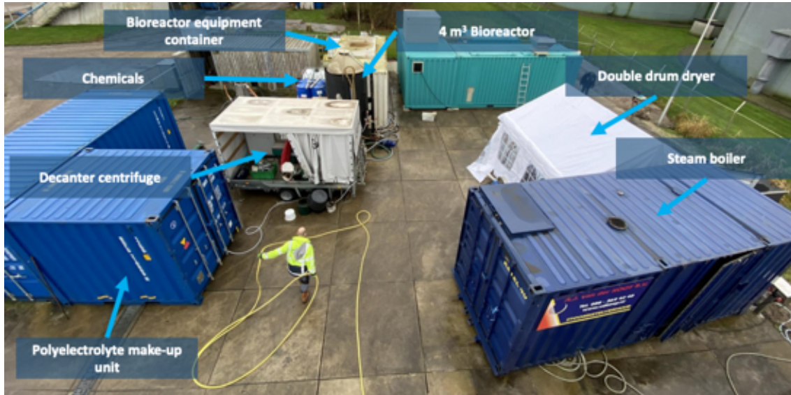
FIGUUR 5 IMPRESSIE VAN DE TIJDELIJKE PRODUCTIE VAN PHA-RIJK HALFFABRICAAT OP DE RWZI LEEUWARDEN
