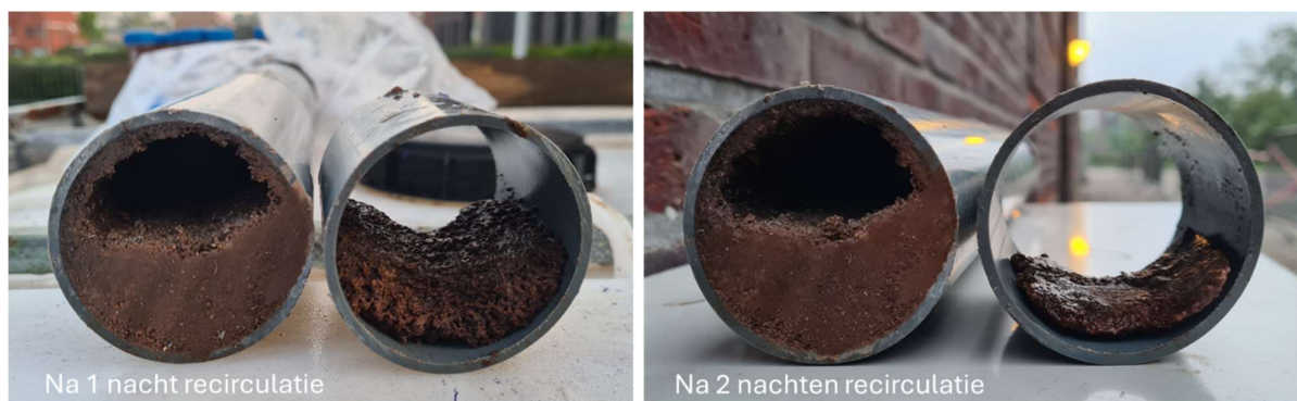
Figuur 4.2 Effect van recirculeren op het klein stukje leidingdeel in doseerbak
