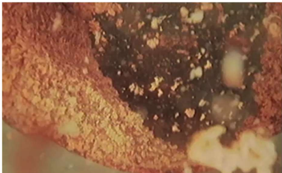
Figuur B5.17 In de 'pocket'. Camera onder water. 'Pocket' zo goed als helemaal schoon met op één plek nog een brok afzettingen zichtbaar
