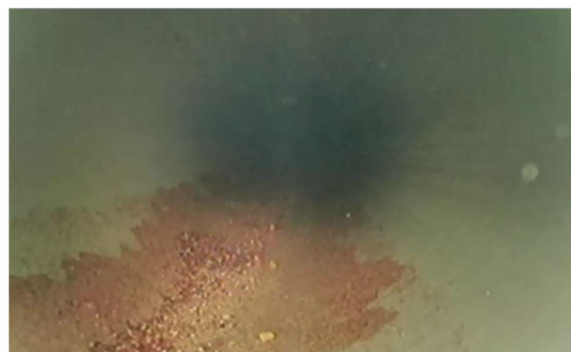
Figuur B2.9 Links: geen beeld van, omdat camera niet door voorgaande bocht kwam. Rechts: camera onder water, onder in leiding ligt wat gruis
