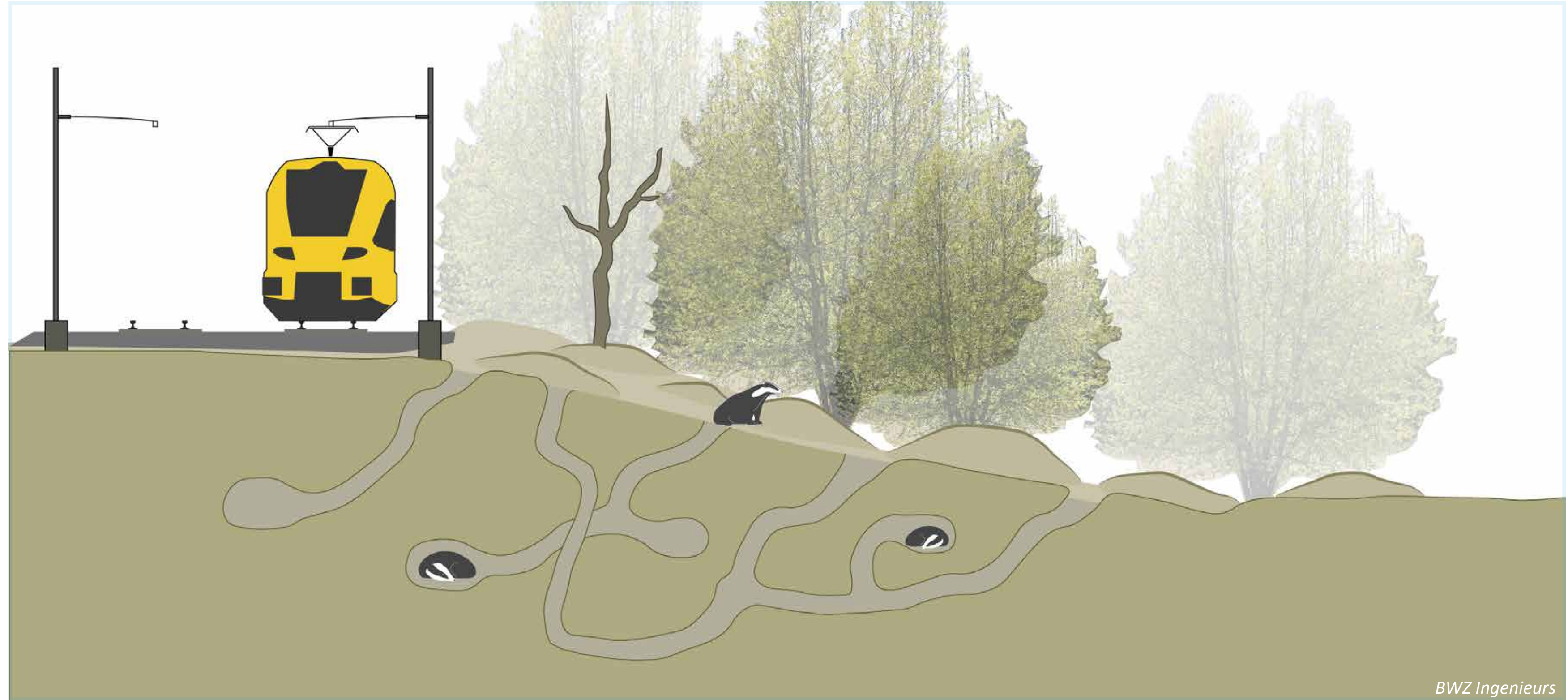
schematische weergave van een dassenburcht deels onder het spoor
