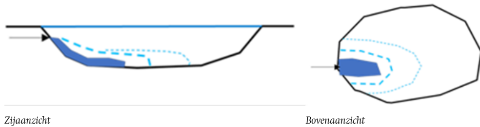
AFBEELDING 3.3 SCHEMATISCHE WEERGAVE VAN HET VERWACHTE GEDRAG VAN EEN KOUDEPLUIM VANAF HET LOZINGSPUNT (ZWARTE PIJL) IN EEN ONDIEP STILSTAAND MEER, MET IN DONKERBLAUW DE MENGZONE, EN IN LICHTERBLAUWE STIPPELLIJNEN DE ISOTHERMEN VAN DE KOUDEPLUIM
