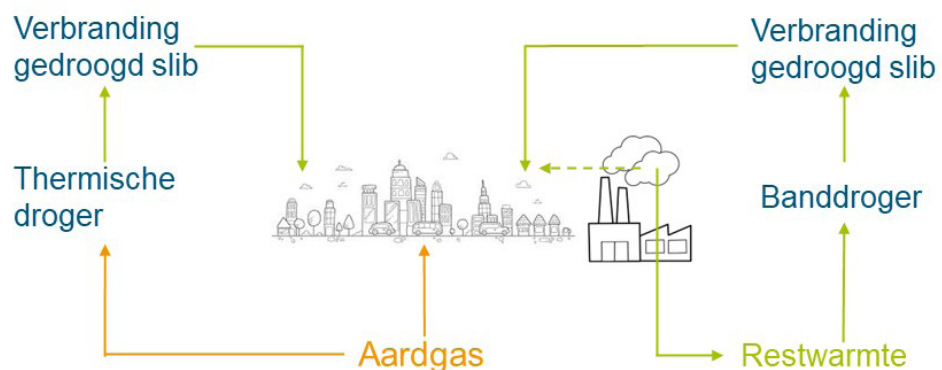
FIGUUR 20 SCHEMATISCHE WEERGAVE ALS ILLUSTRATIE VOOR DE POTENTIËLE ENERGIEWINST BIJ HET GEBRUIK VAN RESTWARMTE VOOR HET DROGEN VAN SLIB, MAAR DE WEERGAVE DIENST ALS ILLUSTRATIE OM BIJ HET OPSTELLEN VAN EEN ENERGIEBALANS VERDER TE KIJKEN DAN ALLEEN DE SLIBVERWERKINGSINSTALLATIES
